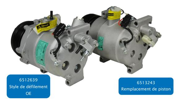
Le compresseur de piston est un remplacement boulonné direct pour la conception de modèle défilement de l'équipement d'origine. La conception du piston Gpd tolère mieux les résidus laissés dans le système de c/a et fonctionne mieux à bas régime que la conception de défilement de l'équipement d'origine. Quel que soit le compresseur utilisé, gpd recommande fortement de laver le système et de remplacer le condenseur.
