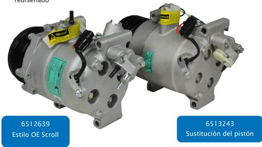
El compresor de pistón es un reemplazo directo y atornillado para el diseño de estilo scroll del equipo original. El diseño de pistón de gpd es más tolerante a los residuos que quedan en el sistema de A/C y funciona mejor a bajas RPM que el diseño scroll del equipo original. Independientemente del compresor que se utilice, gpd recomienda encarecidamente lavar el sistema y sustituir el condensador.
