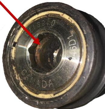
La poulie de découplage doit être propre et exempte de rouille ou de résidus.
