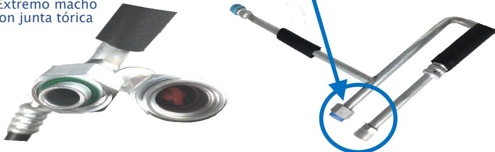
2. Retire las tapas de plástico. El extremo hembra del 4811269 tendrá un tubo de orificio (3411250) en línea. El extremo macho tendrá una junta tórica. Lubrique la junta tórica con aceite mineral (8011234).
