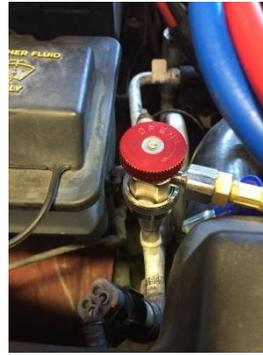
4. Conecte los conectores del lado de baja y de alta. La línea azul irá al lado de baja y la roja al de alta. Debido al diseño de los conectores, no puede colocar la línea equivocada en la conexión equivocada. Atornille los conectores para que queden bien ajustados y sin fugas.
