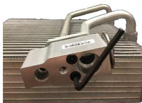
4. Raccorder la valve d'expansion à la quincaillerie à l'aide d'un hexagone de 4 mm pour installer les vis inclus dans le kit de quincaillerie.
