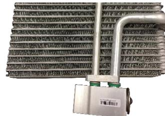
3. Raccorder la valve d'expansion aux conduites de l'évaporateur pour s'assurer qu'elle est installée dans la bonne direction (figure 3).
