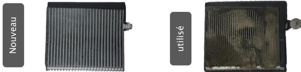
Pendant le processus d'échange de chaleur, l'évaporateur extrait la chaleur et l'humidité de l'air à l'intérieur du véhicule, ce qui provoque la condensation de l'humidité à l'extérieur de l'évaporateur et des ailettes du véhicule. C'est ce qui est plus visible par temps humide lorsqu'une flaque d'eau se forme sous la voiture, du côté passager. Il provient de l'humidité qui s'écoule de la face de l'évaporateur et qui quitte le véhicule par un tube de drainage.
