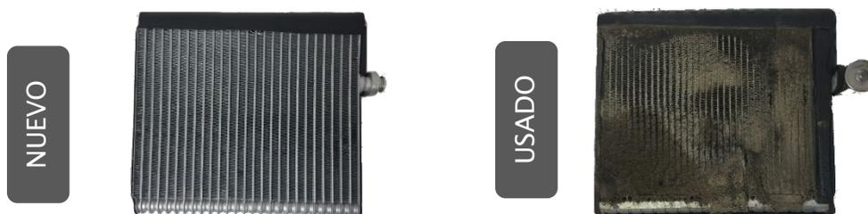
Durante el proceso de intercambio de calor, el evaporador extrae el calor y la humedad del aire del interior del vehículo, lo que provoca la condensación de la humedad en el exterior del evaporador y de las aletas del mismo. Esto es más notable en un día húmedo cuando se forma un charco de agua debajo del coche, en el lado del pasajero. Se origina en la humedad que fluye desde la cara del evaporador y que sale del vehículo a través de un tubo de drenaje.
