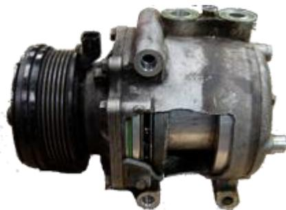
En cas de panne du compresseur d'un véhicule équipé d'un condenseur à flux parallèle, nous recommandons au technicien de remplacer l'accumulateur, le tube d'orifice ou le dispositif d'expansion et le condenseur. Nous recommandons également que tous les autres composants soient rincés pour s'assurer qu'ils sont exempts de contaminants susceptibles d'endommager le nouveau compresseur.
