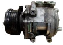
Ante un fallo del compresor en un vehículo equipado con condensador de flujo paralelo, recomendamos que el técnico sustituya el acumulador, el tubo de orificio o el dispositivo de expansión y el condensador. También recomendamos que se laven todos los demás componentes para garantizar que estén libres de contaminantes que puedan dañar el nuevo compresor.
