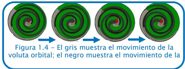
El refrigerante se comprime entre la espiral orbital y la estacionaria (figura 1.4). La abertura de entrada aspira el gas. Este gas se comprime en el centro de la espiral. A medida que la voluta orbita, la abertura se hace más pequeña, la presión aumenta y el refrigerante es forzado a salir por la descarga en la parte trasera del compresor.
