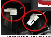
2. Lorsque l'appareil est éteint, débranchez le connecteur de la thermistance.
