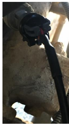
3. Raccorder l'appareil de contrôle du transducteur de pression entre le commutateur du transducteur et le connecteur électrique.
