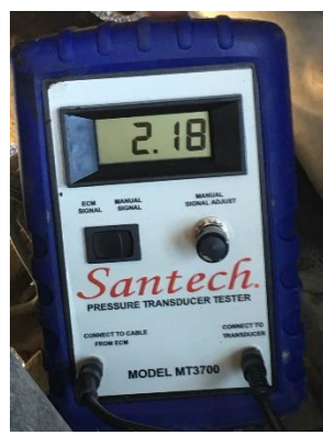
4. Lors du démarrage du véhicule, l'énergie doit être raccordée à l'appareil de contrôle. Cette image montre le signal de tension de l'ECM.
