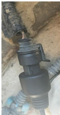
3. Raccorder l'appareil de contrôle du transducteur de pression entre le commutateur du transducteur et le connecteur électrique.
