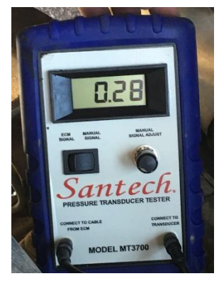
5. En mode signal manuel, vous pouvez contrôler la tension atteignant le transducteur pour vérifier qu'il fonctionne dans les bons paramètres.
