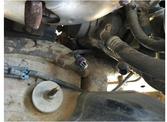
2. Débranchez l'interrupteur du transducteur.
