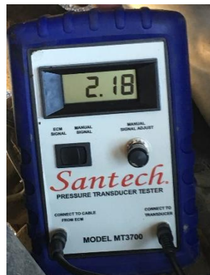
4. Al arrancar el vehículo, la energía se conectará al probador. Esta imagen muestra la señal de tensión del ECM.
