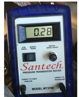
5. En el modo de señal manual, puede controlar la tensión que llega al transductor para comprobar que funciona dentro de los parámetros correctos.
