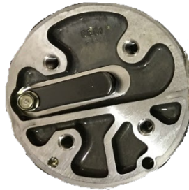
Figura 1.3: Zona de descarga en la parte posterior del Scroll
