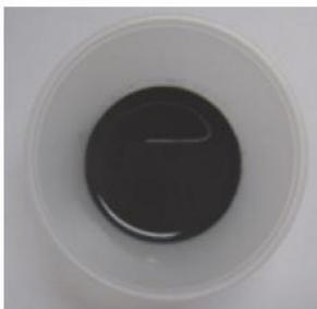
Une huile de compresseur de cet aspect indique que le compresseur s'est échauffé et que le système est
