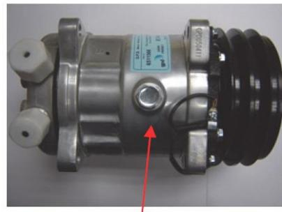
Vérifiez toujours l'huile sur un compresseur défectueux et sur un compresseur neuf. Défaites le bouchon
