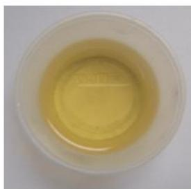
L'huile du compresseur doit être propre. Il faut toujours vérifier la présence de contaminants dans l'huile.
