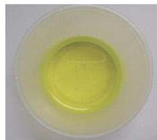
L'huile de compresseur avec colorant doit être propre et de couleur verte. Vérifiez toujours la présence de contaminants
