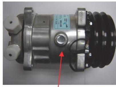
Compruebe siempre el aceite del compresor averiado y del compresor nuevo. Desenrosque el tapón para extraer el aceite.
