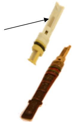
Figura 1.1 – El color del tubo de orificio identifica el tamaño del diámetro.
