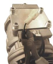
4. Placez le connecteur de butt sur le câble exposé et accrochez-le en place.
