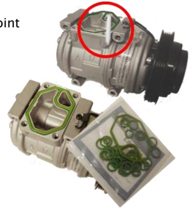
6. Si vous avez acheté un kit de compresseur gpd, il sera fourni avec un kit de joint torique à étanchéité rapide. Localisez le joint collecteur et placez-le dans le compresseur où se trouvait l'ancien.
