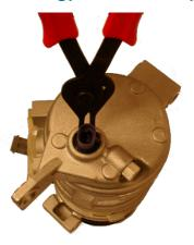
Empiece por quitar el anillo de seguridad, sujetando presostato del compresor en su sitio
