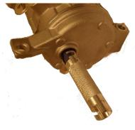
Coloque el 5811423 en la posición alrededor del interruptor. Gire y bloquee el interruptor. Tire para retirar el interruptor.
