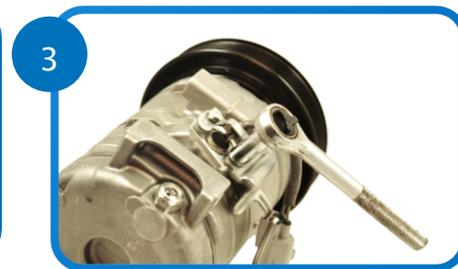
3. Retirer les vis de 2 7 mm de l'interrupteur.
