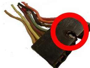
El 1711755 es un pigtail de reemplazo de la resistencia del motor del soplador que viene con el mismo código de colores que el arnés de cableado e incluye el encogimiento de calor sobre los conectores a tope. Todo lo que tiene que hacer es cortar el viejo conector pigtail, hacer coincidir los colores de los cables y luego engarzar las líneas. Por último, con una fuente de calor, calentar los conectores termorretráctiles para impermeabilizarlos.
