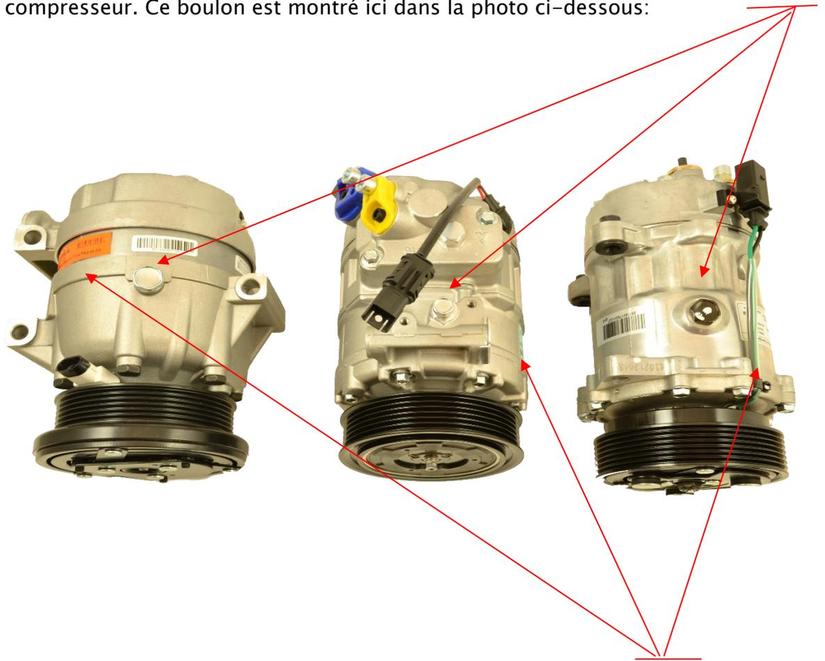
La bonne quantité d'huile pour le compresseur se trouve ici sur le côté du compresseur. Notez que si vous essayez de vérifier le niveau d'huile à partir de la connexion du collecteur, vous n'trouverez pas une mesure correcte. La seule façon de vérifier correctement l'huile est de vider complètement le compresseur à travers le bouchon de remplissage d'huile comme indiqué ci-dessus.
