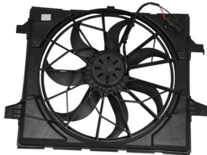
2811733 – Assemblage du ventilateur de refroidissement
