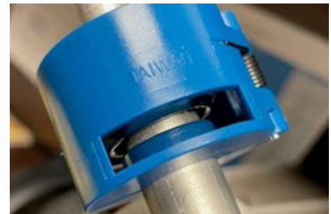
Lorsque les extrémités mâle et femelle sont connectées, le spring se verrouille sur une lèvre. Un "clic" audible signale une connexion sécurisée.
