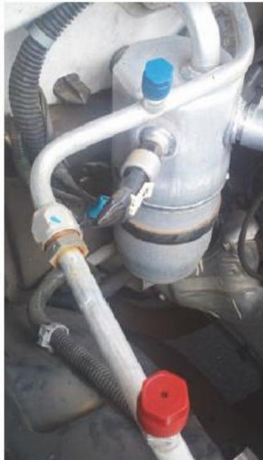
Los puertos de servicio del lado bajo y alto en algunas aplicaciones GM, con el tubo de orificio en el centro.
