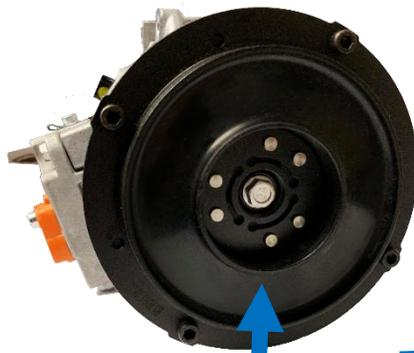
La surface d'embrayage est plus grande que le style accueillir un roulement d'embrayage plus grand et bobine d'embrayage plus forte.
