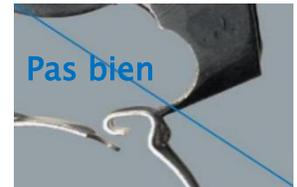
Si les pinces ne sont pas gardées dans un carré pendant la fermeture du clip, la fermeture peut avoir un décalage. Utilisez la pince pour corriger l'alignement de la fermeture. Le nez des pinces doit être solidement réglé sous le montage du renflement et du loquet de verrouillage.
