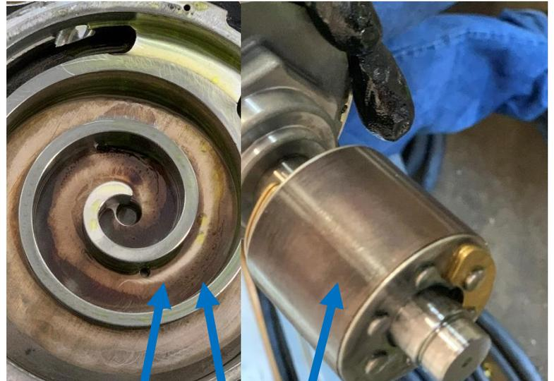
Le rouleau stationnaire stationnaire stationnaire à gauche est situé au centre du compresseur et est l'endroit où le liquide de refroidissement est paysédant. Consultez la fiche technique gpd #54 pour une description détaillée des compresseurs à rouleaux. Les images ci-dessus montrent des signes d'arc électrique (marques de brûlures gris foncé/brun) en raison de la haute pression et des faibles propriétés diélectriques de l'huile.
