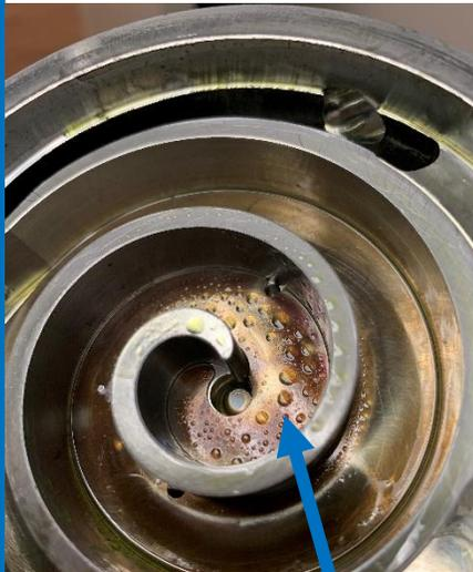
Sur cette image, les gouttelettes d'eau montrent que l'humidité a été introduite dans le système. Ceci est particulièrement aux hybrides compresseurs qui transportent de l'électricité à haute tension.
