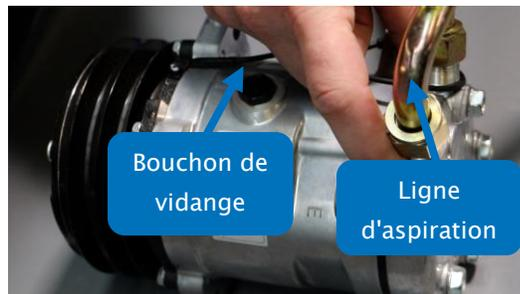
Le traitement ACEP de 1 oz. Le traitement ACEP peut également être versé dans le compresseur par l'orifice du compresseur. Veuillez noter que l'emplacement de l'orifice varie en fonction de l'application et qu'un amorçage peut être nécessaire pour certains types de compresseurs.
