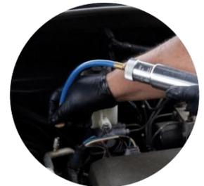
Connectez l'injecteur au port de service A/C et tournez lentement la poignée jusqu'à ce que le traitement ACEP soit entièrement injecté (voir les instructions fournies avec le kit d'injecteur pour une utilisation correcte).
