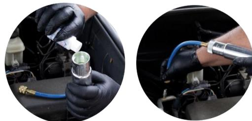
Conecte el inyector al puerto de servicio de A/C y gire lentamente la manivela hasta que el tratamiento ACEP se inyecte por completo (consulte las instrucciones incluidas con el kit de inyector para su uso correcto).
