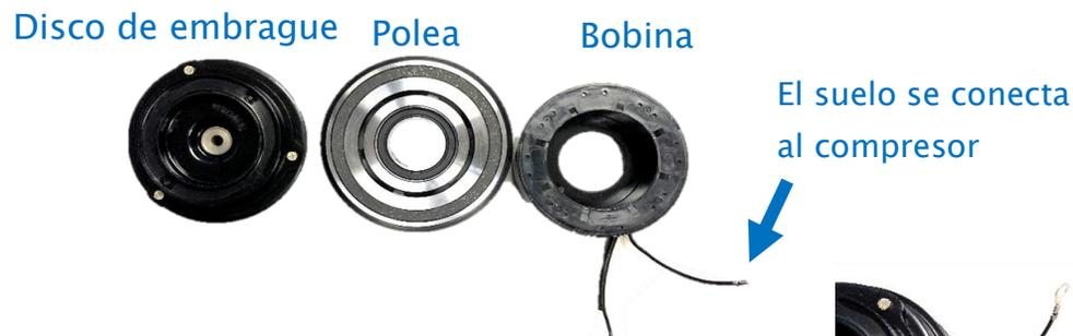
2. Ensamble el embrague e identifique el cable de alimentación que va a la fuente de alimentación del vehículo.
