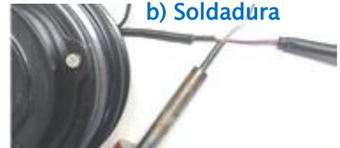
5. Localice la cinta de tierra, la conexión de ojal unida al compresor, donde se encontraba la última cinta de tierra. Ponga cinta adhesiva o retráctil térmico en la conexión para que sea estanca y no pueda producirse un cortocircuito en otra superficie
