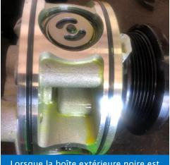
Lorsque la boîte extérieure noire est retirée, vous pouvez voir les pistons et le côté échappement/décharge. C'est là que le liquide de refroidissement entre en jeu, puis circule autour de l'orifice de décharge. Cette conception est la raison pour laquelle le compresseur R4 d'origine a fui au fil du temps.
