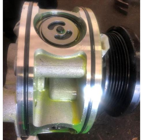
Cuando se retira la caja exterior negra, puede ver los pistones y el lado de escape / descarga. Aquí es donde el refrigerante entra y luego fluye alrededor del puerto de descarga. Este diseño es la razón por la que el compresor R4 original se filtró con el tiempo.
