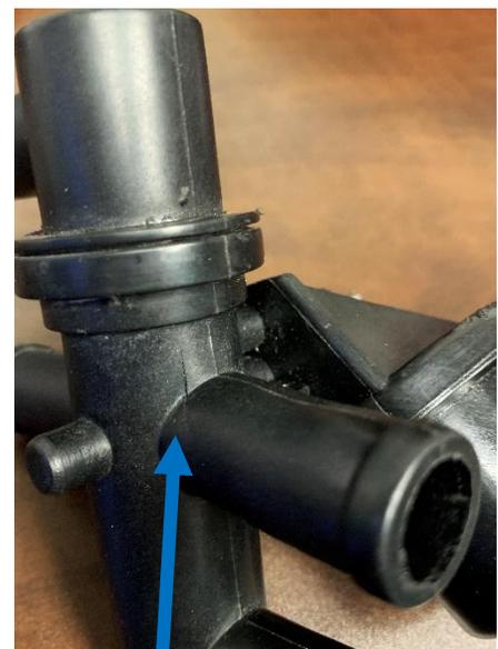
L'excès de torsion a fait plier le tube et s'est séparé du logement principal.
