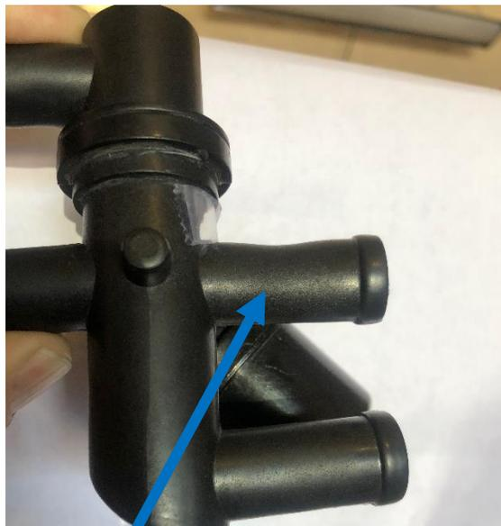
Remarquez la courbe dans la valve de chauffage. Ici, un outil électrique utilisé trop de couple causant le tuyau à plier.
