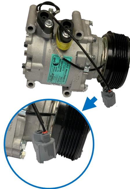
Lors du remplacement d'un compresseur, il est bon de remplacer la valve d'expansion de la sécheuse et les joints toriques.
